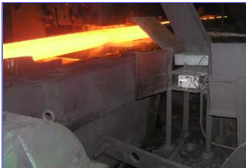
Bild 5: optischen Messgeräten für Kontrolle der Vorblock - Schnittlänge
